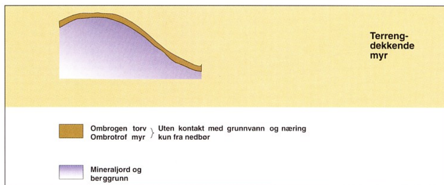
Figur 5.1. Skjematisk framstilling av terrengdekkende myr. Etter Moen (1998).
