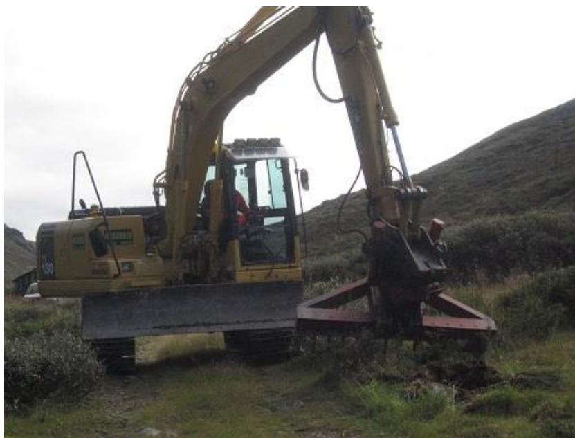
Figur 11. Gravemaskin med svans for rydding av einer, markdag 31.08.2011. Foto: Jenny Kristin Heggvold.
