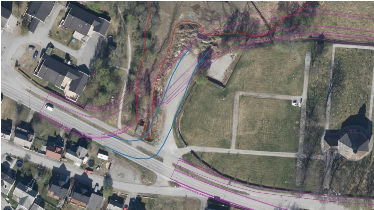
Figur 10. Forslag til justering av avkjørsel for midlertidig vei vest for Grytten kirke (med blå strek). Plan mottatt fra Statens vegvesen med fiolett strek, naturtypelokkaiet med rød strek. En T-kryss-lignende veiform med en skarpere sving vil spare deler av keila, som antas å være vanskelig å restaurere vellykket i etterkant.
