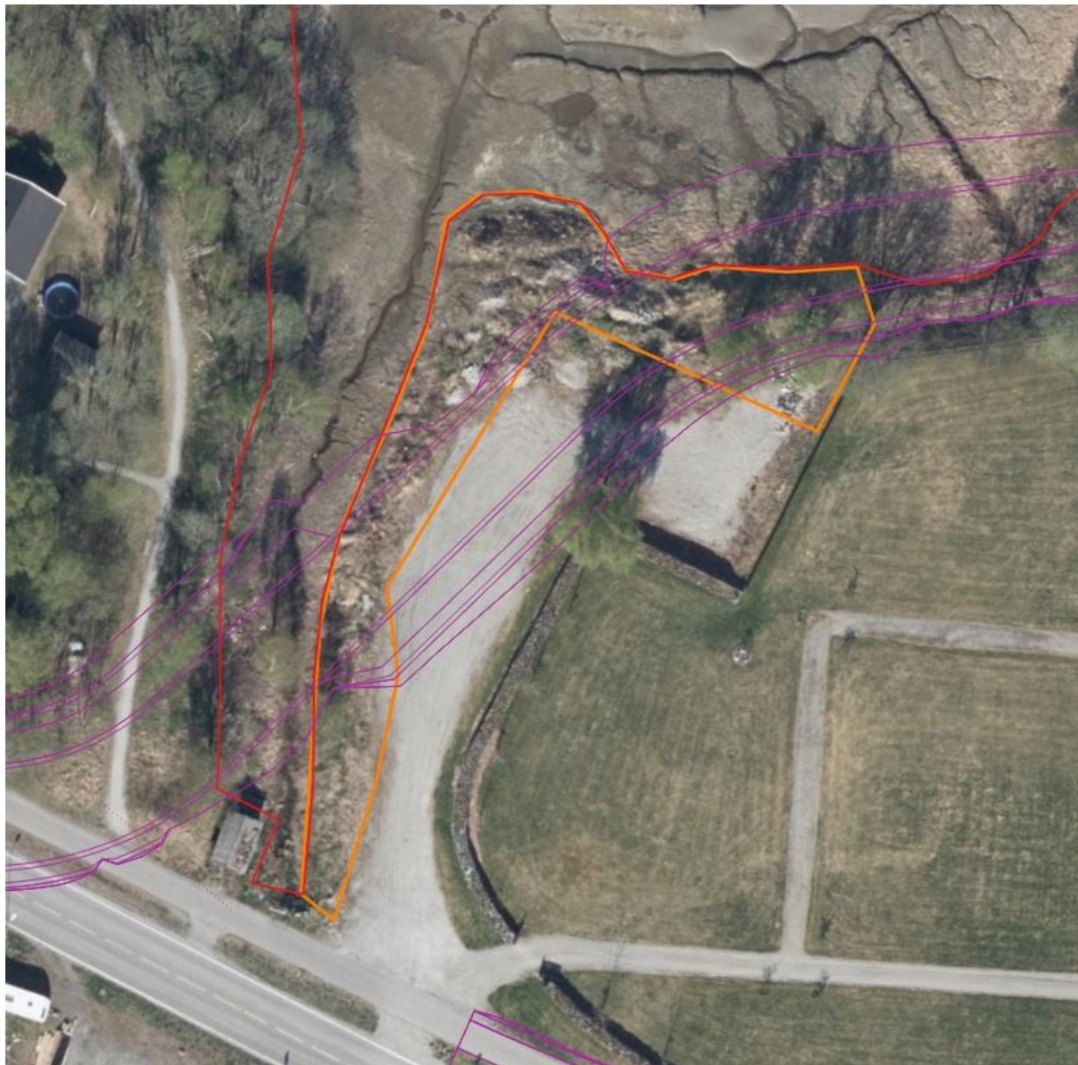
Figur 11. Forslag til kompenserende tiltak vest for Grytten kirke (med oransje strek). Plan mottatt fra Statens vegvesen med fiolett strek, naturtypelokalitet med rød strek. Hvis denne grusplassen skal være en permanent parkeringsplass, foreslås den asfaltert og avgrensning av parkeringsplassen markeres med en mur som ikke inviterer til videre fylling og dumping av hageavfall. Arealet innenfor oransje strek vil dermed kunne restaureres tilbake til strandeng som det var tidligere, ved at fyllmasser fjernes. Samtidig oppnås fjerning av et viktig spredningsareal for fremmede arter.
